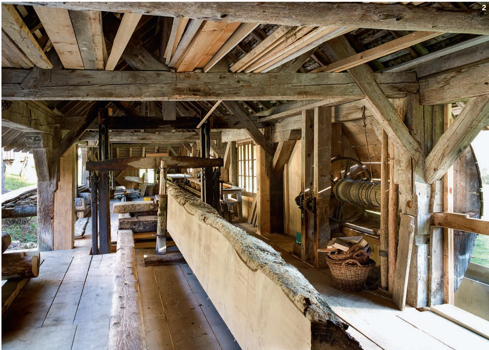
**2** Une scierie classique conservant la scie à cadre qui, à l'aide d'une bielle manivelle, permet au mouvement circulaire de se transformer en mouvement vertical et au chariot de se déplacer sur un rail.
