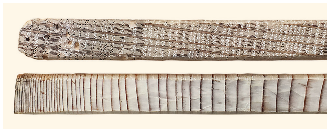
Bohrkerne für die Jahrringmessung. Oben: Eiche aus Fraubrunnen, gefällt 1700 n. Chr.; unten: Fichte aus Adelboden, gefällt 1631 n. Chr.
