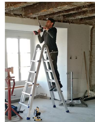
Prélèvement d'un échantillon de bois au château de Berthoud. Les arbres des poutres massives du plafond en épicéa et en sapin blanc ont été abattus en 1200 apr. J.-C., transformés et probablement utilisés peu après.
