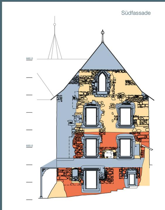
Fassaden des mutmasslichen Chorherrenhofs mit den Bauphasen. Rot: Kernbau (Südflügel) von 1222; gelb: An- und Ausbau des späten 15. Jahrhunderts; blau: Umbau von 1847.
